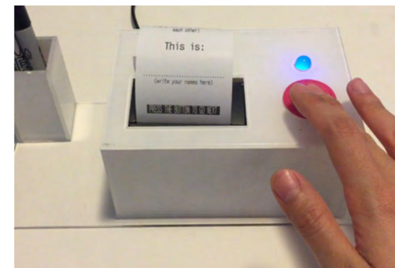
(圖 3) ENGAGE—使用 Arduino 與熱感壓紙製作的互動裝置
